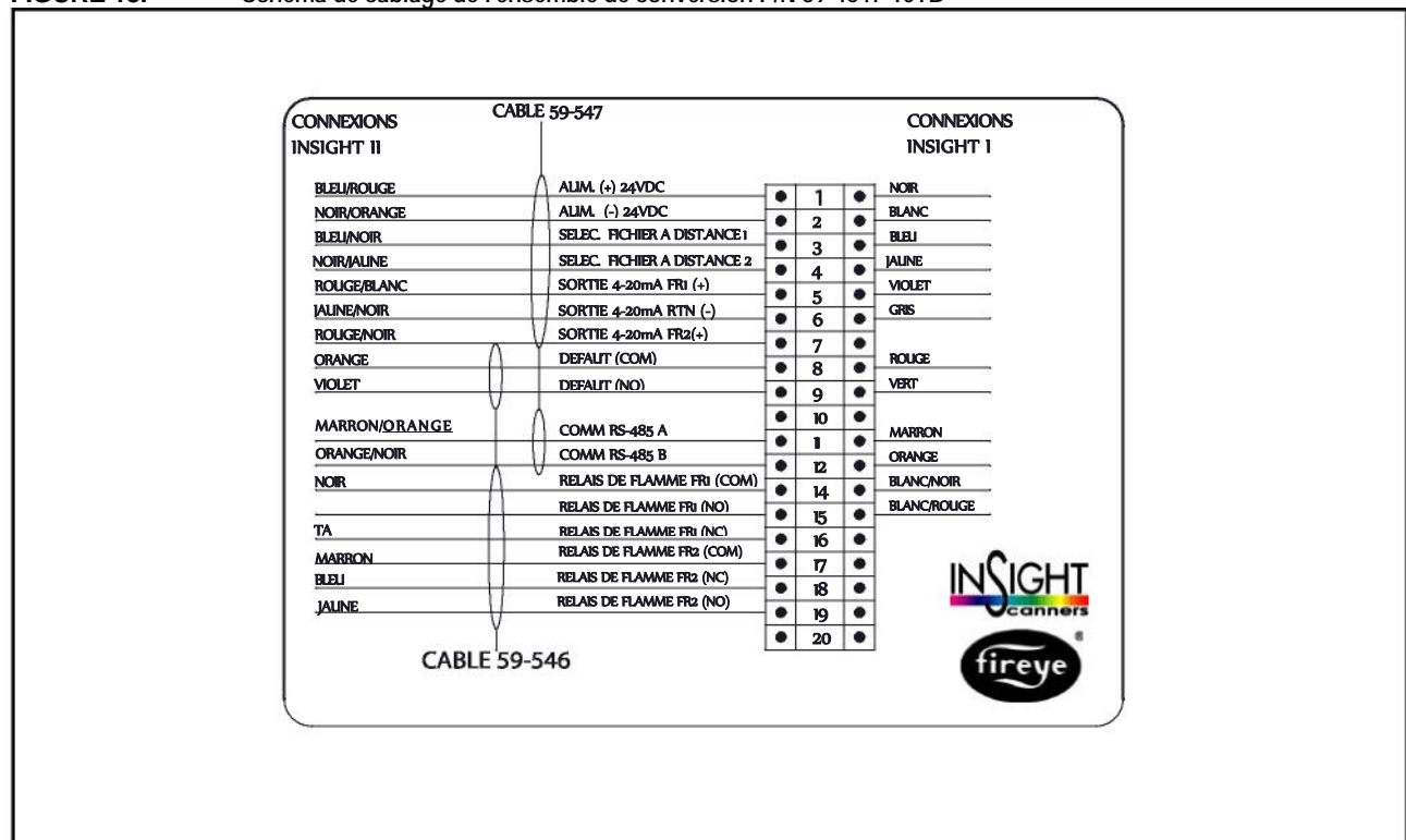
FIGURE 18. Schéma de câblage de l'ensemble de conversion P/N 59-4647-10TB
