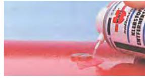
2. Vaporiser le Dissolvant pour Adhésif directement dans l'espace entre l'adhésif et la surface et permettre un bref temps d'action.
