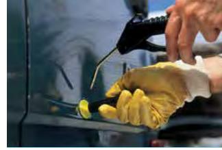
3. Coller l'adaptateur sur le point le plus profond de la bosse, si possible, refroidir avec de l'air pressurisé. De cette manière, la bosse pourra être étirée après environ 30-40 secondes.
