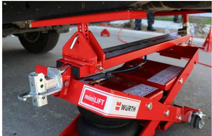
Élévation latérale avec patin de levage (inclut avec **Art. No. 995.110ML**)
