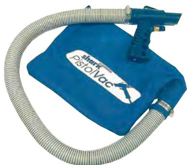
**Note:** Faire fonctionner en mode aspirateur seulement avec un sac de poussière en tissu fermement attaché par une attache pour tuyau. Faire fonctionner avec l'air réglé à un maximum de 90 PSI et avec un tuyau de réserve d'air 3/8". Toujours utiliser des lunettes de sécurité, voir Préfixe 899. Les normes OSI-1A exige un maximum de 30 PSI lors du fonctionnement de l'aspirateur pistolet en mode ventilation.
