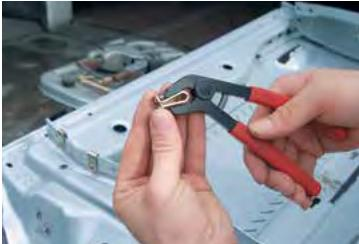
1. Insérer l'étrier de fixation dans la pince spéciale et ouvrir l'étrier.
