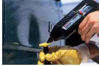
2. Placer l'adaptateur nécessaire sur le manche et appliquer de la colle sur le milieu de l'adaptateur. Les nouveaux adaptateurs doivent être brossés pour une meilleure adhérence.
