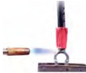
**3.** Pendant que la soudure fond, laissez glisser le câble dans la borne jusqu'à ce que l'installation soit serrée contre le haut de la borne. Éloignez la source de chaleur. Glissez le tube thermo-rétractable au-dessus de la connexion. Appliquez une chaleur indirecte sur le tube.
