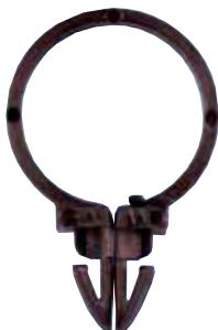
Une méthode rapide, économique pour l'attache de fils, tuyaux, durites ou tiges de diamètre 1/4" à 1" sur des surfaces métalliques, plastiques ou diverses ayant une épaisseur de 1/32" à 1/8". Ces clips sont composés de plastique nylon noir durable. Ils se fixent dans des trous de diamètre 1/4" et sont tenus fermement en place par des "pointes retournées" flexibles qui compensent les variations d'épaisseur des parois.
