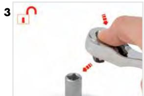
3 Verrouillage sécurisé avec blocage rapide pour déverrouiller.
