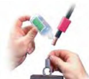
**1.** Dénuder le câble de taille appropriée afin que sa partie exposée atteigne le fond du terminal de batterie. L'installation du câble doit s'adapter avec facilement contre le bout du terminal. Insérez la bonne taille de cylindre à souder et appliquer le flux de soudage.
