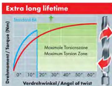
**Embout hautes performances pour opérations de vissage difficiles, tout particulièrement pour une utilisation avec des clés à chocs tangentielles.**
