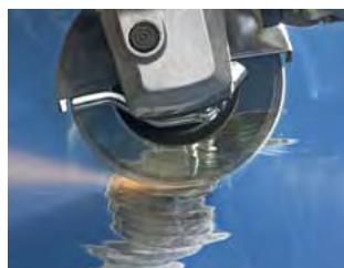
Ponçage avec le disque fendu transparent Zebra : bonne vue du matériau en cours de traitement
