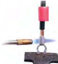
**2.** Sécuriser le terminal de batterie dans un étau. Glissez la bonne taille de tube thermo-rétractable au-dessus du câble. Chauffez la base de la borne tout en appliquant doucement vers le bas une pression sur le câble.
