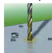
En raison de l'adhérence de particules d'huile sur l'outil d'usinage, une action de lubrification à long terme est ainsi atteinte.
