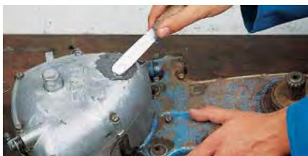
Réparation des panneaux de couverture du moteur de petite taille.
