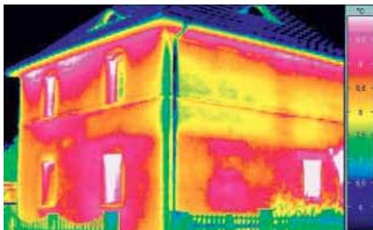
En raison des mouvements et expansions longitudinales qu'occasionnent les fluctuations de température sur les bâtiments, les mousses de PU les plus courantes sont davantage susceptibles de se déchirer, en particulier dans le cas de fenêtres de couleur foncée. Danger de création de ponts thermiques. Le joint de raccord de bâtiment qui fuit peut être rendu visible grâce à la thermographie (zones rouges).
