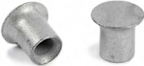
Pour réaliser une jointure avec rivet auto-perceur, on presse un rivet auto-perceur à l'aide d'un outil spécialisé (pistolet à rivets auto-perceurs) pour fixer deux ou plusieurs feuilles de matériau à travers les métaux à assembler. Pour ce faire, une filière est utilisée. La tôle inférieure est fixée à la tôle supérieure sans la percer. Chaque fabricant a une filière qui correspond à leurs exigences OEM et avec laquelle existe une similitude visuelle.
