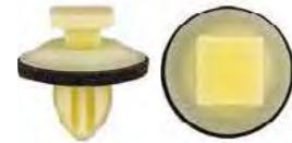
**Clip de moulure entrée d'air aile, bas de caisse avec joint, nylon jaune**
